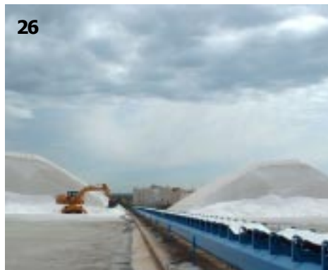
26. Retroexcavadora recogiendo la sal apilada.
