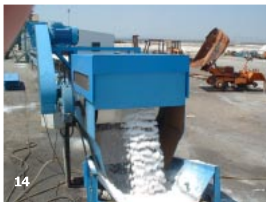
14. La sal pasa al transportador inclinado.
