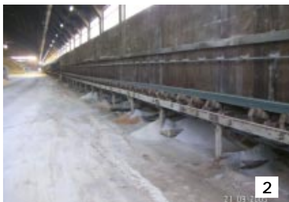
Foto 3: Detalle del fertilizante en polvo que descargan nuestras bandas DRAGO 30CC desde transportadores aéreos.
