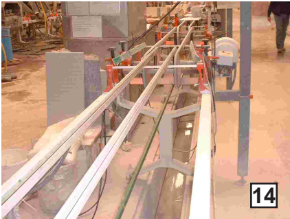
Línea de termosoldable hacia el acabado de piezas.
