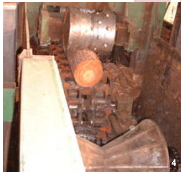
D) “Peladora”: Elimina la corteza del tronco (foto 4)
