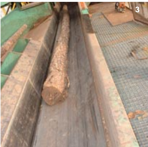
C) Transportador de entrada a “Peladora”: Equipa banda de caucho (foto 3)
