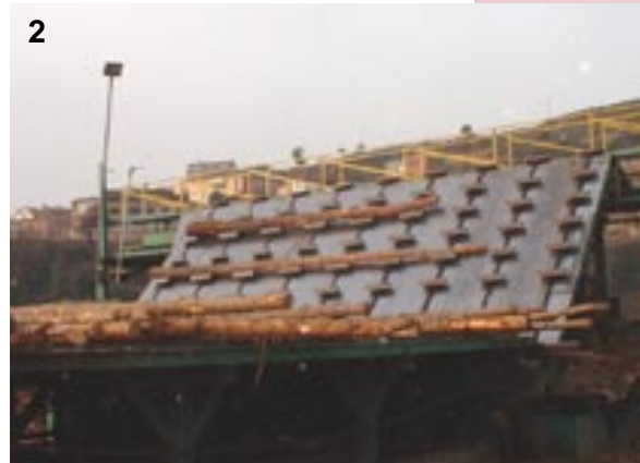
B) Cargador de entrada: Transportador de cadena (foto 2)
